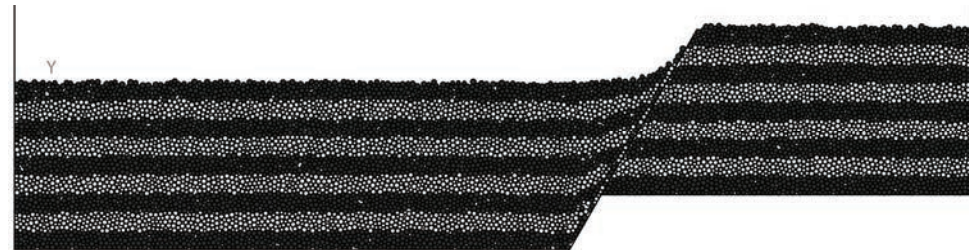
図 21(d) 正断層運動による堆積層の変形。地表にまで正断層が達している場合。
