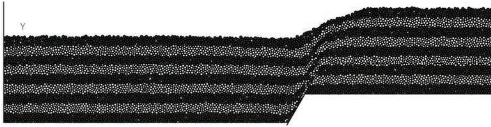
図 21(a) 正断層運動による堆積層の変形。堆積層中に層厚の 30%だけ正断層が達している場合。
