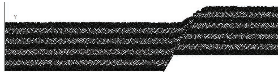
図 21(c) 正断層運動による堆積層の変形。堆積層中に層厚の 80%まで正断層が達している場合。
