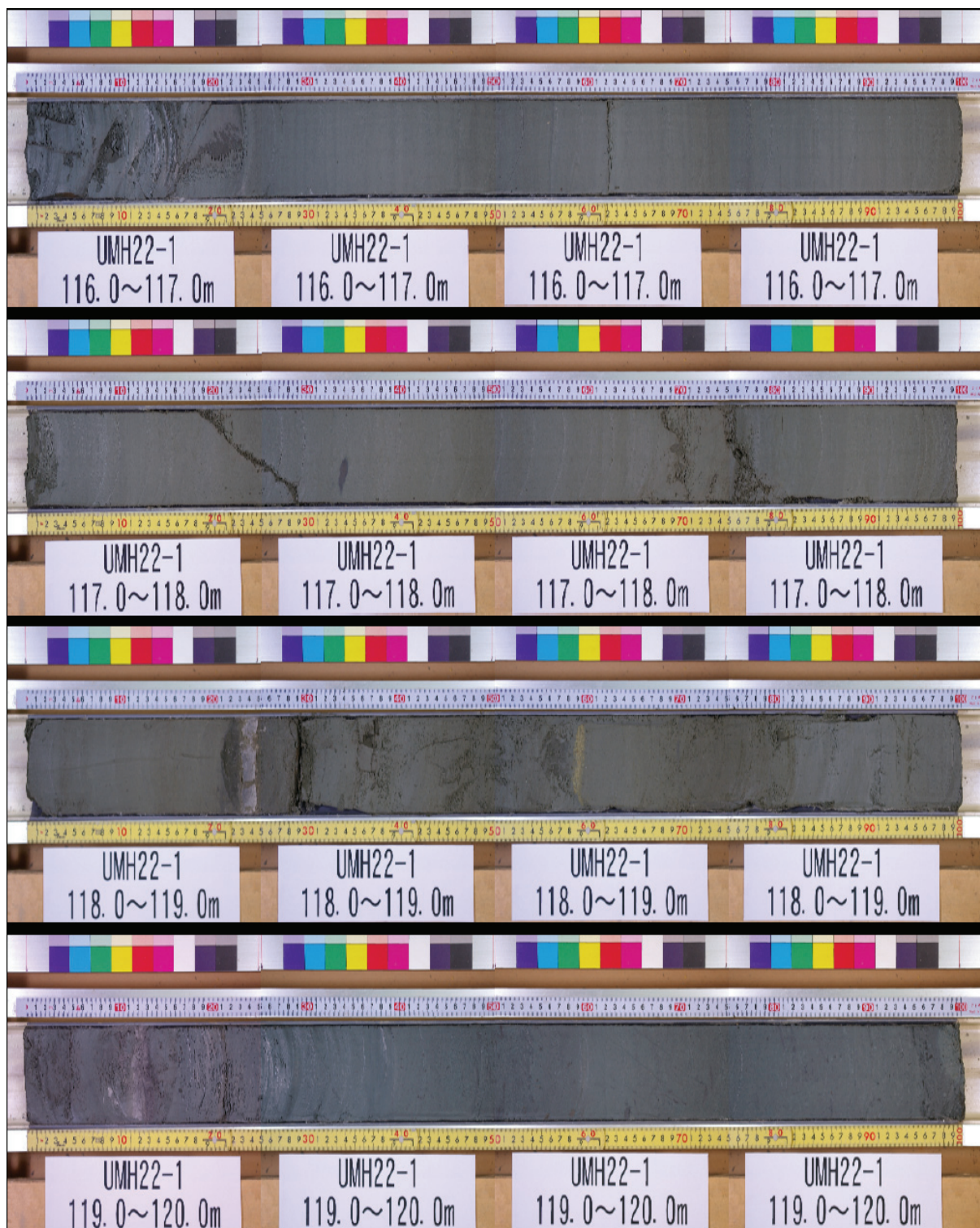
元町中公園におけるボーリング調査のコア例（深度 116-120m、粘性土の部分）
