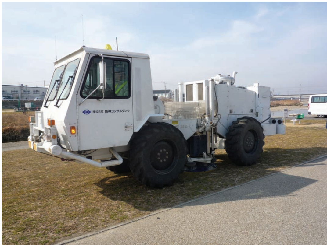
大津川河川敷における中型バイブレータによる発震の様子
