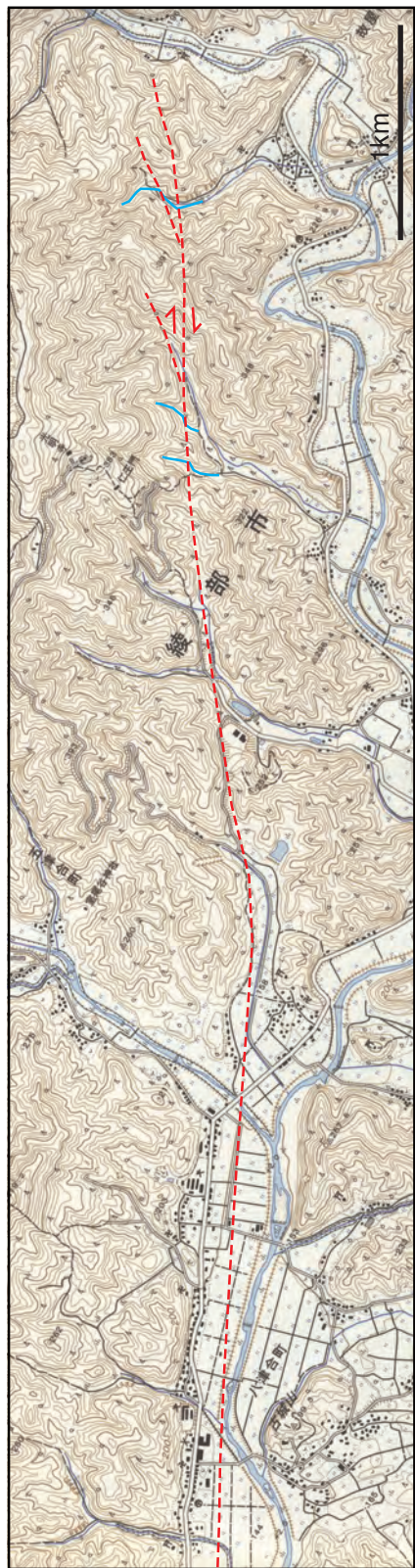
図2 上林川断層のストリップマップ (国土地理院発行1/25,000地形図「綾部」「梅迫」「丹波大町」を使用) 凡例 赤線：活断層 (破線部は推定), 青線：横ずれ屈曲河谷
