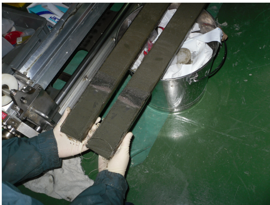
NT13-02（なつしま）による海底堆積物の採取地点（上）。前弧海盆と上部斜面において採泥を実施した。PC 3 の地点のコアを縦割りにしたところ（下）。上部から 250cm 付近に灰-白色の火山灰層が挟存していた。手前がコアの下方方向。
