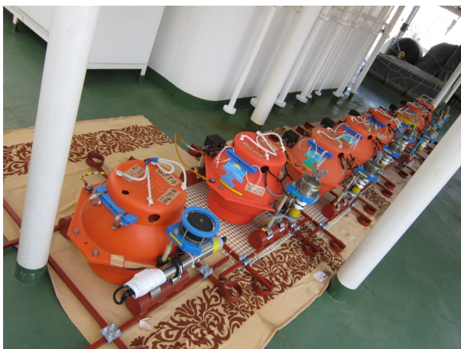
気象庁観測船「凌風丸」 船上で設置を待つ海底水圧計。
