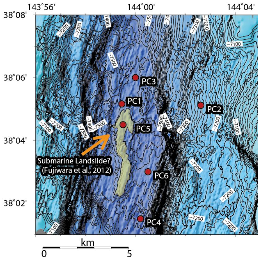
MR12-E01による海底堆積物コアの採取地点と、その周辺の地形図。地震後に出現した海底地すべり（図中にSubmarine Landslide?と表記）と考えられる地形的高まりを淡緑色で示す。
