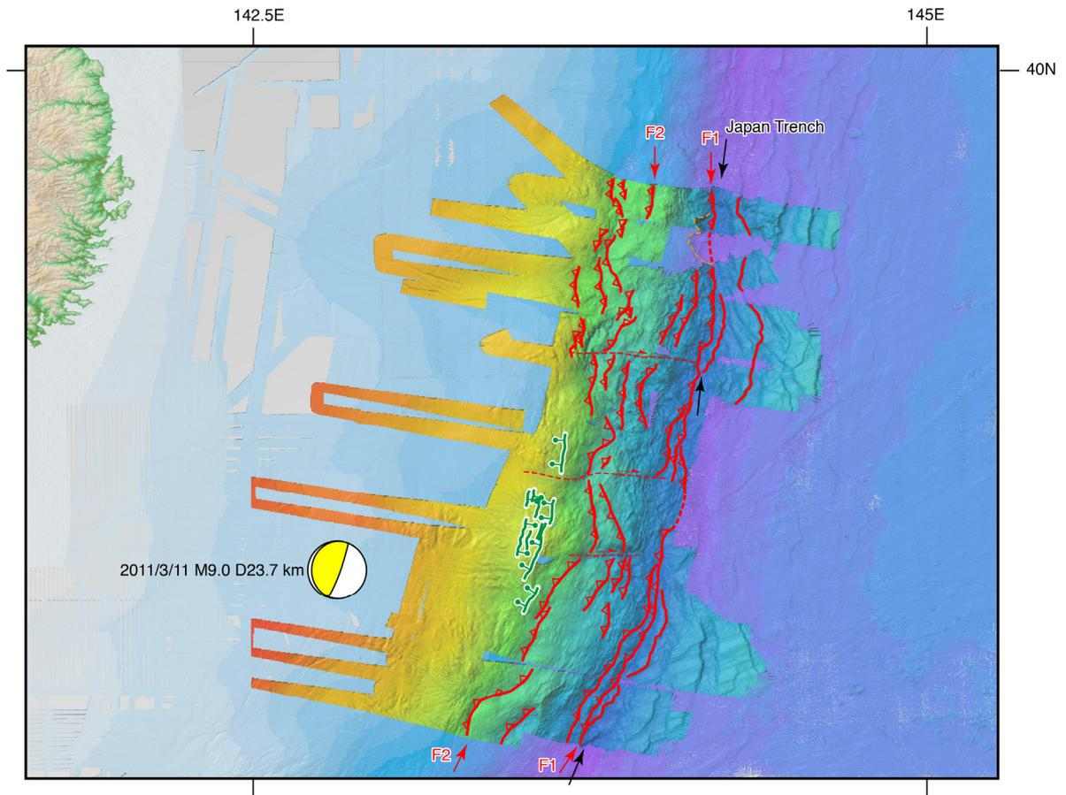
地震後の300 mグリッド海底地形データにもとづく予察的な震源域の活断層図。赤線（断層線）の△側は逆断層の上盤側を示す。背景はJTopo30を使用。震源域の海溝軸と海溝陸側斜面にほぼ連続して逆断層が分布することがわかる。一方、東西走向のtear faultが海溝陸側斜面を切って分布し、F1・F2上盤側の背斜軸跡に右横ずれ変位を与えている。
