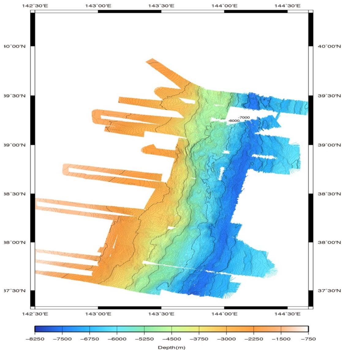
変動地形の解析に使用した地震後の300 mグリッド海底地形データ。海洋研究開発機構の航海YK11-E06 Leg1(期間:2011年7月11日～2011年7月27日)で取得されたデータに基づき、作成した。
