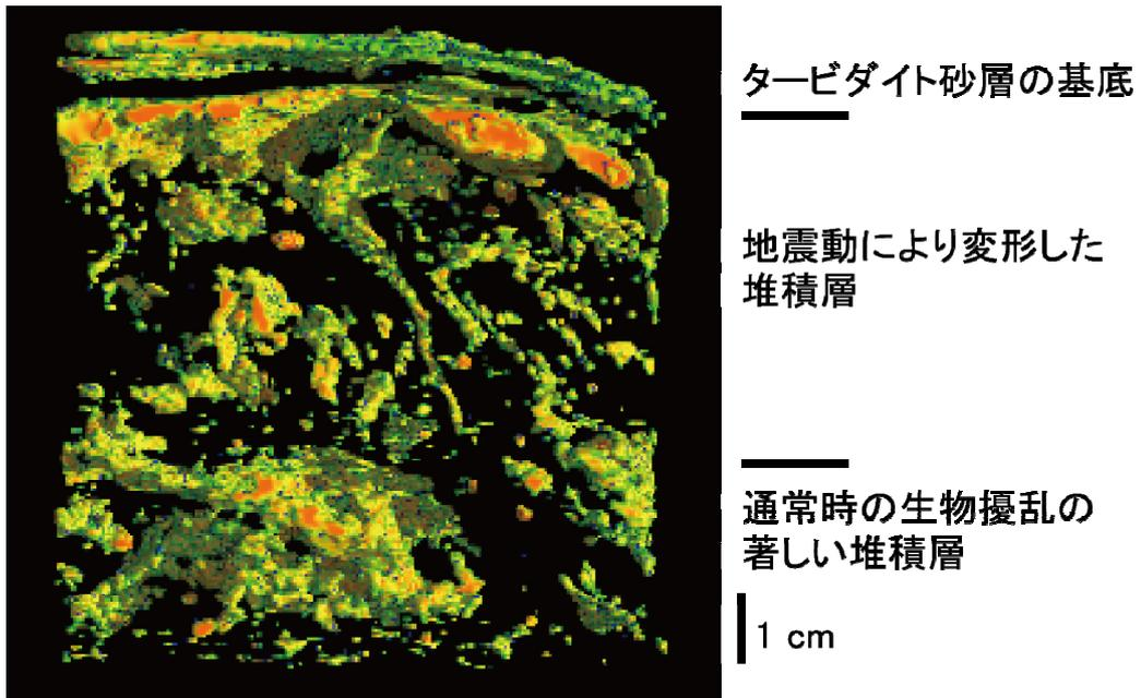
仙台沖から淡青丸 KT-11-17 航海で採取された表層堆積物試料にみられる地震動により変形した堆積層の X 線 CT 三次元画像。青から緑、オレンジ、赤に向かって密度が大きくなる。
