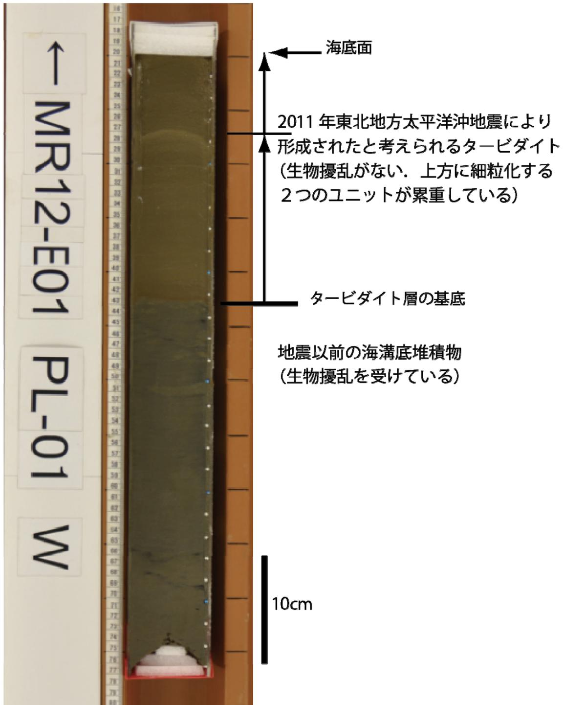
「みらい」MR12-E01航海で震源域近傍の日本海溝から採取されたコアの最表層にはタービダイト（茶色の部分）が確認された。生物擾乱がないことから最近の堆積物と考えられ、2011年東北地方太平洋沖地震時に発生した混濁流からの堆積物と考えられる。
