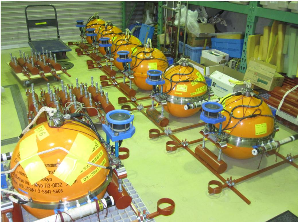
整備の完了した広帯域海底地震計（上）と長期観測型海底地震計（下）。広帯域海底地震計により、低周波イベント等の観測を行う。本年度は、東北地方太平洋沖地震震源域南部に設置する広帯域海底地震計及び長期観測型海底地震計計 40 台の整備が完了した。
