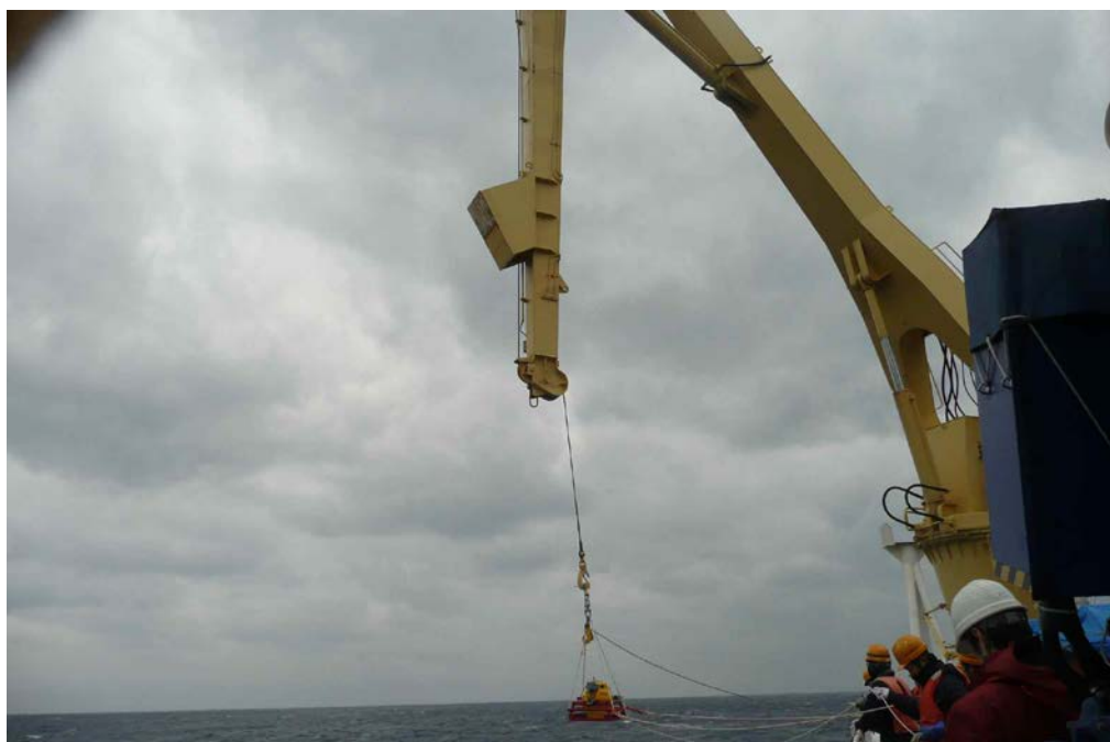
図3 「みらい」のクレーンを使った自由落下方式による広帯域海底地震計設置作業
