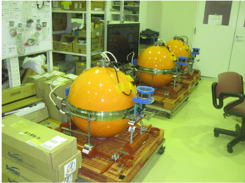
図 5. 整備の完了した広帯域海底地震計
