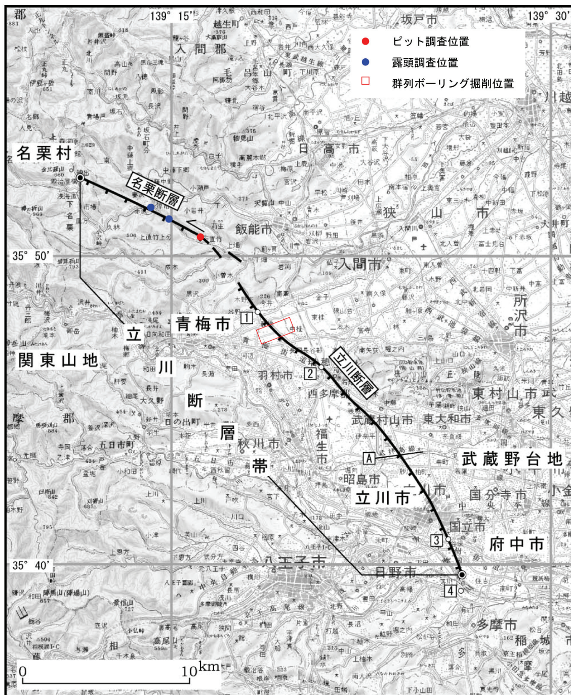
図1 立川断層帯の位置図(地震調査研究推進本部、2003)と調査地点。赤丸：名栗断層下直竹地点ピット調査、青丸：破碎帯の記載地点、赤枠：金子台群列ボーリング地点。
