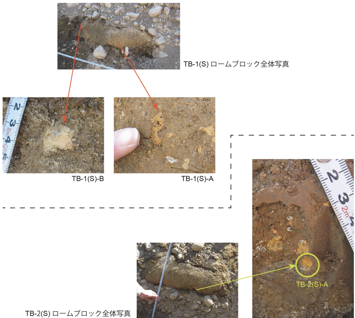
図10 榎トレンチ壁面で採取した火山灰土ブロックとその中に含まれる軽石粒子
