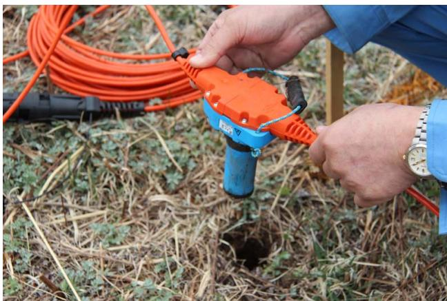
図 5 MEMS 三成分センサー（サーセル社製）
