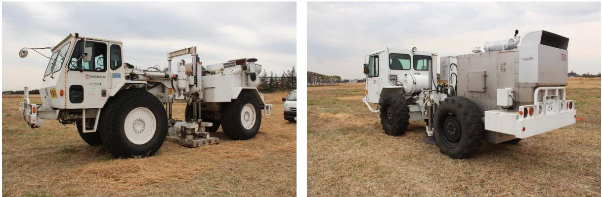
図 4 探査で使用した S 波バイブロサイズ（左）と中型バイブロサイズ（右）
