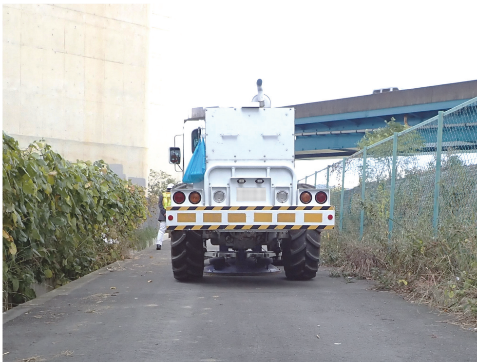
P波反射法地震探査加振風景（巨椋池測線）
