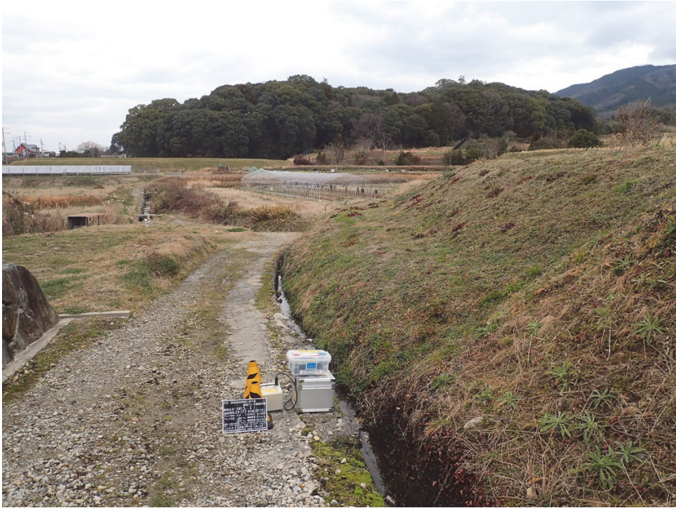
微動アレイ観測風景（桜井測線 NRS-1 の半径 60 m アレイ）
