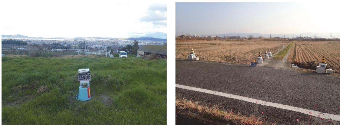
図 48 観測の様子 (左 : 大アレイ観測、右 : 小半径アレイ観測 (4、15 m ))。大アレイ観測では微動計をバケツで覆い風雨の影響を低減。
