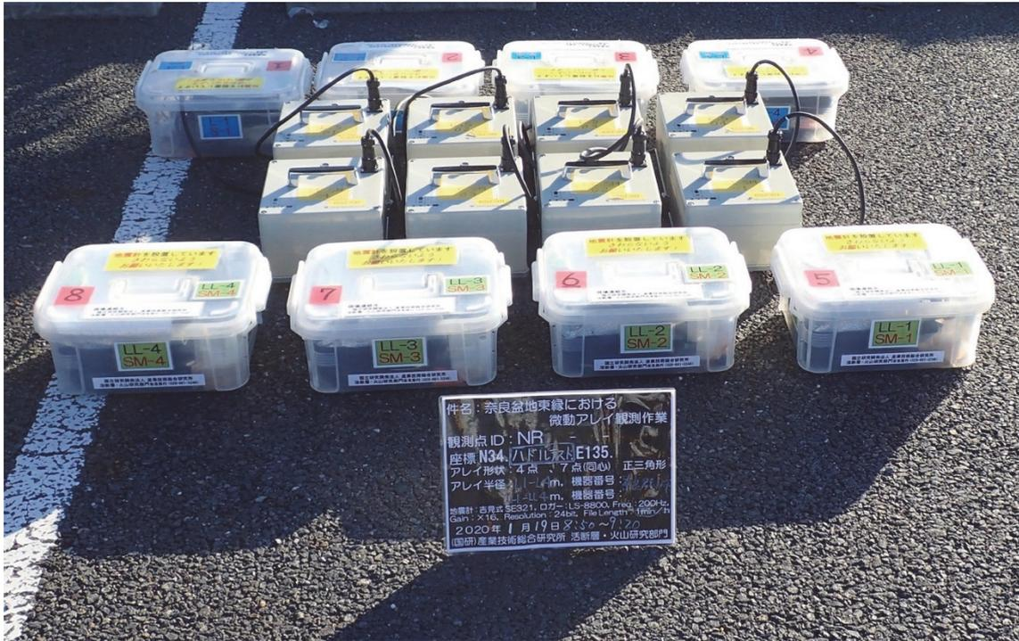
図 47 観測に使用した機器 (東京測振製 SE-321 速度計)
