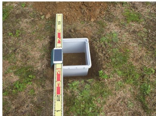
① 設置する地震計およびデータロガー ②表面の土壌を剥ぐ
