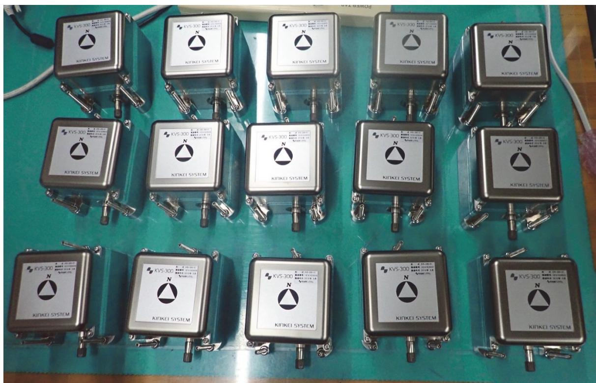
図3 本事業で導入した高感度速度計 (近計システム社製 KVS-300)
