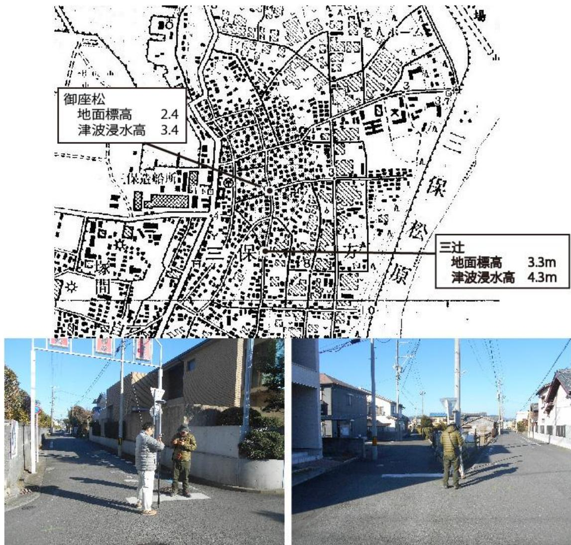
図3-10-⑦-11 静岡市清水区三保の安政津波の浸水高測定。下左写真が御座松交差点 下右写真が三辻。
