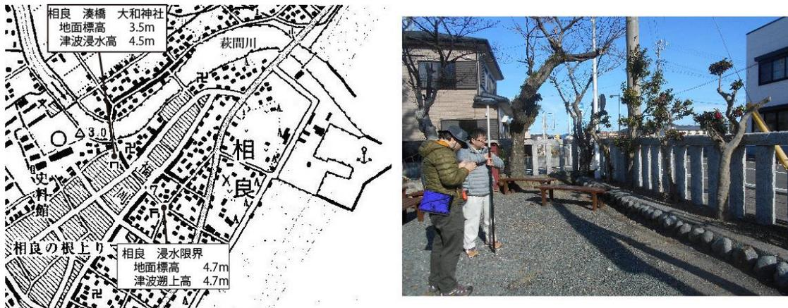
図3-10-⑦-12 牧之原市相良の大和神社での津波標高測定。
