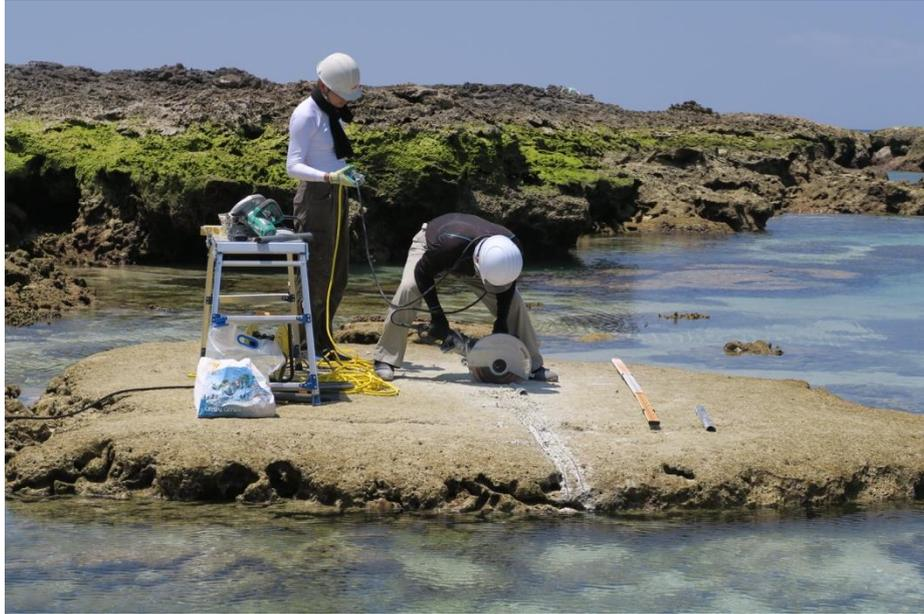
図 3 - 7 - ② - 2 離水サンゴ・マイクロアトールのブロックサンプル採取の様子
