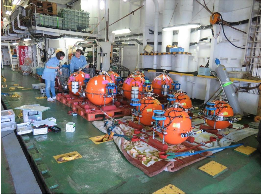
図 3-8-①-4 本年度設置した海底地震計（予備機材を含む）
