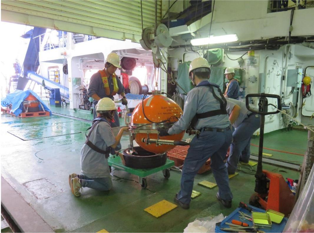
図 3 - 8 - ① - 2 回収された海底地震計
