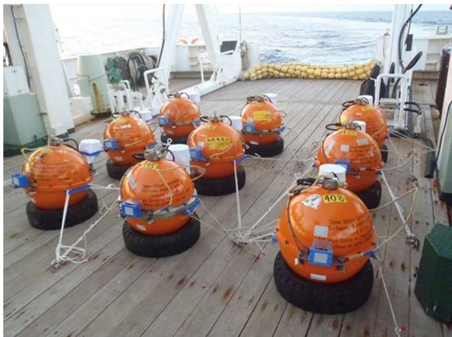
図4 回収された海底地震計
