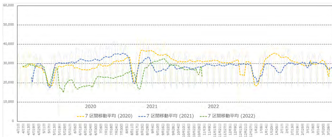
図 2-5-②-5 北系統の企業群に配水された工業用水量の年別推移
