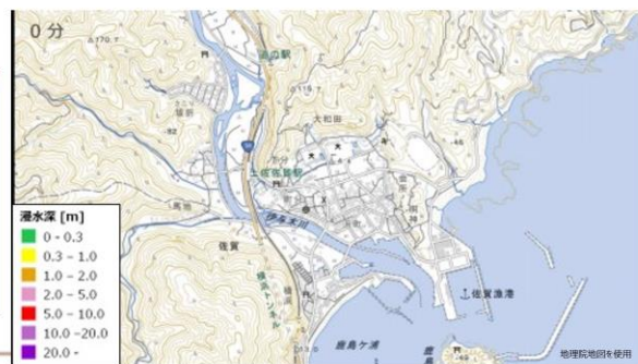
図 2-4-①-3 多様性モデルに基づく「半割れケース」津波浸水シミュレーション (サブ課題 2 (g) の研究成果のインプット)
