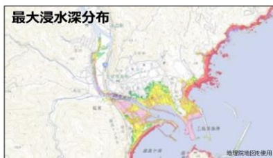
図 2-4-①-3 多様性モデルに基づく「半割れケース」津波浸水シミュレーション (サブ課題 2 (g) の研究成果のインプット)
