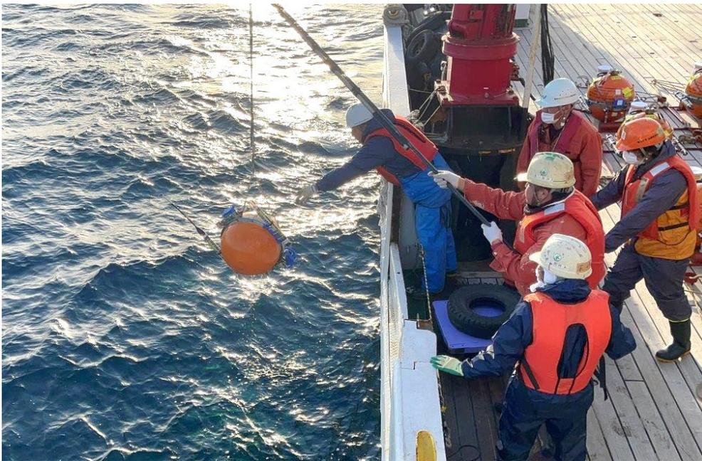
写真 2 - 2 - ③ - 6 海底地震計回収作業の様子。
