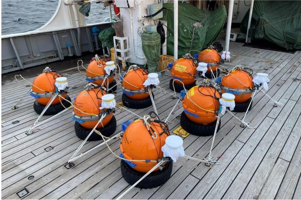
写真 2-2-③-7 回収された海底地震計。
