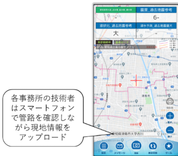
図 2-5-②-14 スマートフォン画面による水道管網表示（調査員）画面
