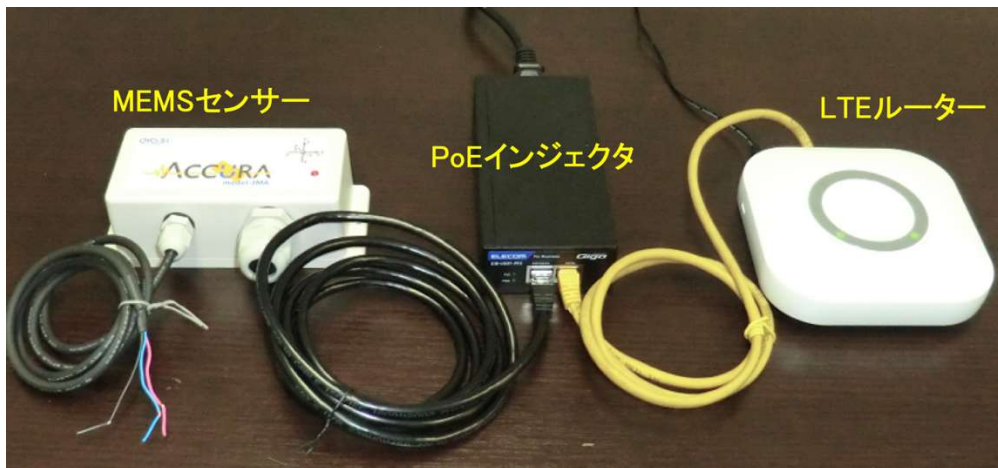
図 2-5-②-10 MEMS センサーの LTE 無線ネット接続による稼働テスト例
