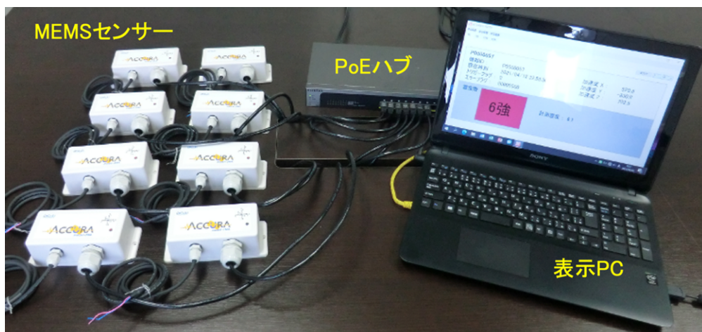
図2-5-②-8 MEMSセンサーの有線ネット接続による稼働テスト
