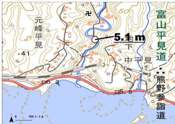
図 2-3-④-35 串本町田子における昭和南海地震の津波痕跡高。国土地理院図（電子国土 Web）を加工。
