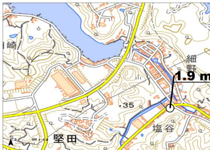
図 2-3-④-31 白浜町堅田における昭和南海地震の津波痕跡高。国土地理院図（電子国土 Web）を加工。
