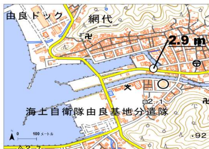
図2-3-④-23 由良町における昭和南海地震の津波痕跡高。国土地理院図(電子国土Web)を加工。
