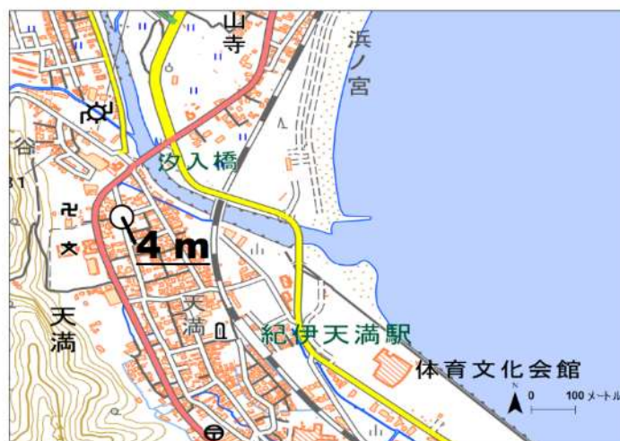
図 2-3-④-21 那智勝浦町天満における昭和東南海地震の津波痕跡高。国土地理院図（電子国土 Web）を加工。
