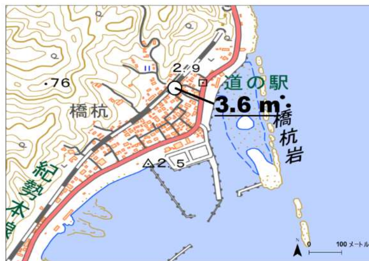
図 2-3-④-45 串本町橋杭における昭和南海地震の津波痕跡高。国土地理院図（電子国土 Web）を加工。
