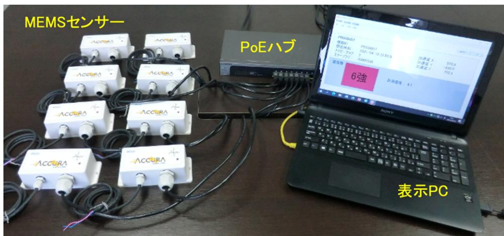
図 2-5-②-8 MEMS センターの有線ネット接続による稼働テスト
