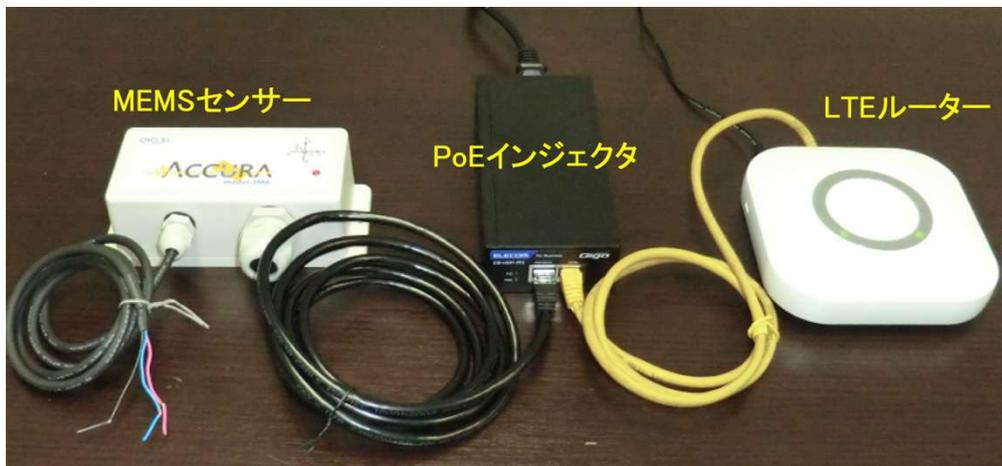
図 2-5-②-10 MEMS センターの LTE 無線ネット接続による稼働テスト例
