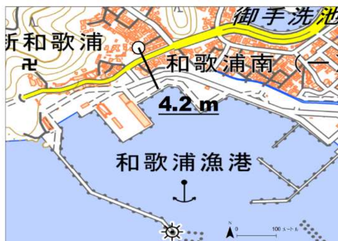
図2-3-④-12 和歌山市和歌浦における昭和南海地震の津波痕跡高。国土地理院図（電子国土Web）を加工。
