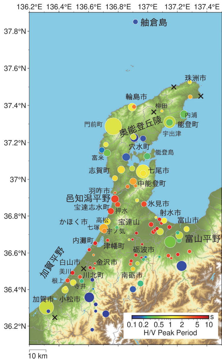
図 104 H/V スペクトル比の卓越周期。丸印の色が卓越周期、大きさがピーク振幅に対応する。×はピークが不明瞭であった地点である。灰色実線は市町村界。基図は SRTM3 (NASA JPL, 2013) を使用して作図。
