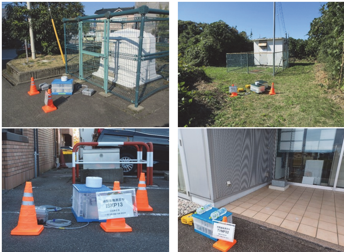
写真 15 単点微動観測の実施状況例 (左上: ISK014 加賀市役所、右上: ISKH01 旧珠洲市立日置小学校、左下: ISKP13 川北町役場、右下: TYMP22 射水市消防本部)。折り畳みコンテナで覆われている白い円筒状の機器が地震計である。
