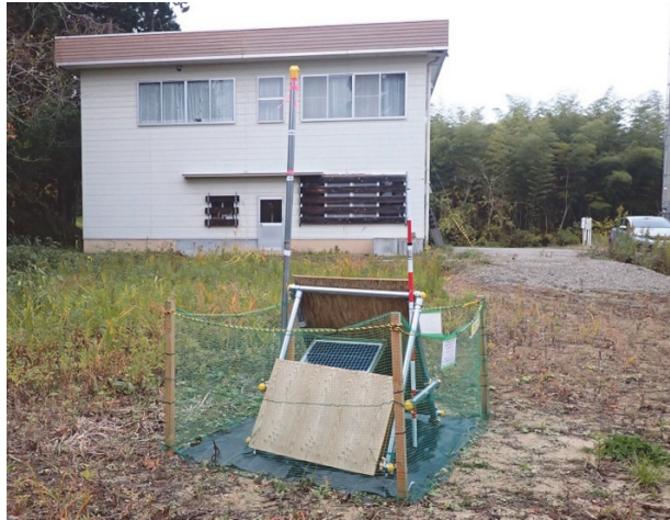
図33 積雪対策 1 回目完了時の様子（ソーラーパネル部分の屋根は外している：MTKV02）
