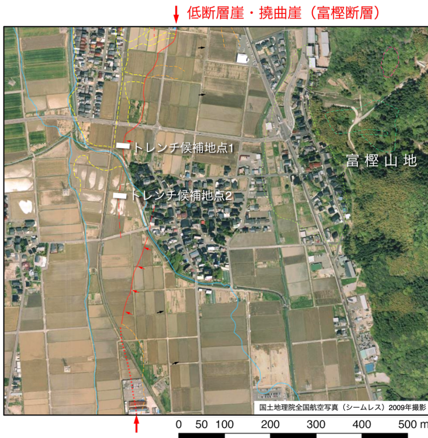
図 16 大縮尺の米軍・国土地理院撮影空中写真の判読と航測図化に基づき推定した撓曲崖の位置。背景は 2009 年撮影国土地理院全国航空写真（シームレス）。トレンチ掘削調査の候補地点を示す。
