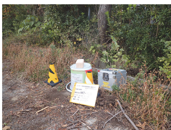
写真25 微動アレイ観測の実施状況(左:HKT、右:YUK)
