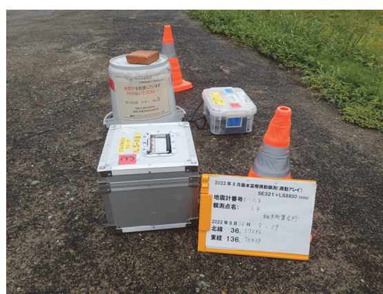
写真25 微動アレイ観測の実施状況(左:HKT、右:YUK)
