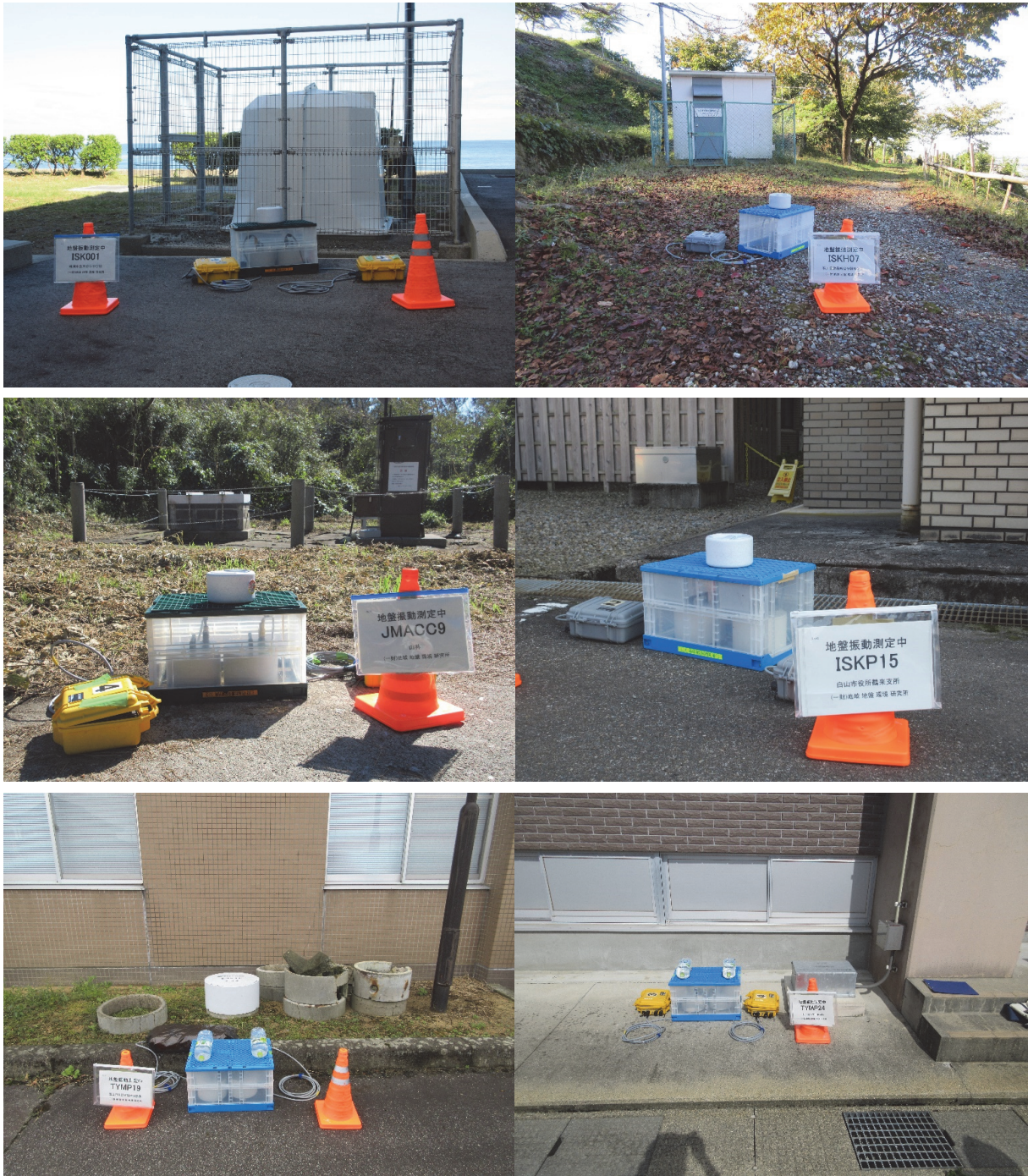
写真 27 単点微動観測の実施状況例（左上：ISK001 珠洲市立大谷小中学校、右上：ISKH07 石川県教員総合研修センター、左中：JMACC9 舳倉島、右中：ISKP15 白山市鶴来支所、左下：TYMP19 富山市消防局婦中消防署、右下：TYMP24 射水市立下村小学校）。折り畳みコンテナで覆われている白い円筒状の機器が地震計である。
