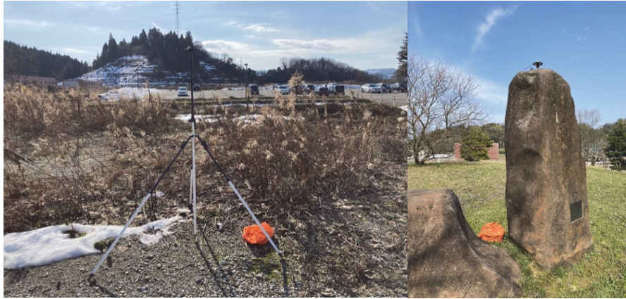
写真1 (左) 2023年1月までのRTK基準点。(右) 2023年2月以降のRTK基準点。共に金沢大学敷地内に位置する。
