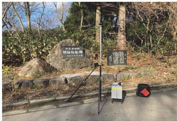
写真2 重力測定時における測定機材（Scintrex CG-3M 重力計と GNSS アンテナ）の設置例。
