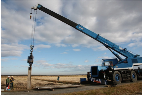
仙台平野におけるジオスライサー採取作業
