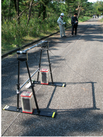
仙台平野南部山元町における GPR を用いた地下構造探査風景
