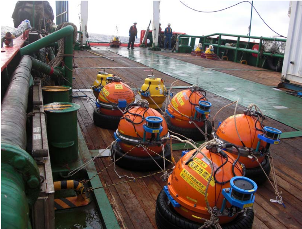
写真11 備船にて回収された長期観測型海底地震計。
