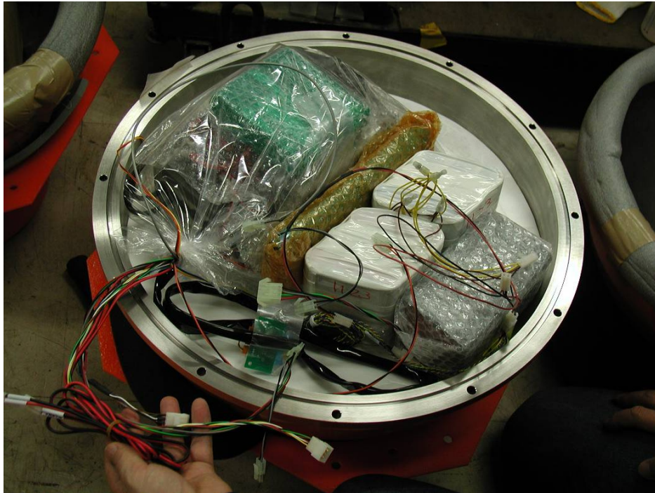
写真5 長期観測型海底地震計。データレコーダとともに音響通信制御装置を取り付けた状態。
