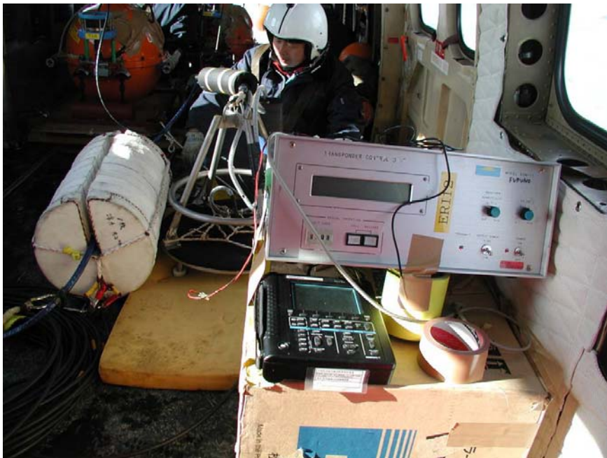
写真10 ヘリコプター機内に搭載された海底地震計の海底設置位置測定システム。
