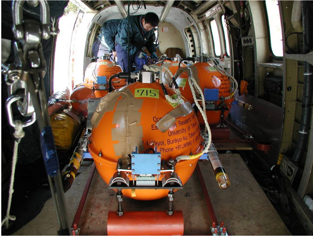
写真9 大型ヘリコプター機内に搭載した5台の長期観測型海底地震計。
