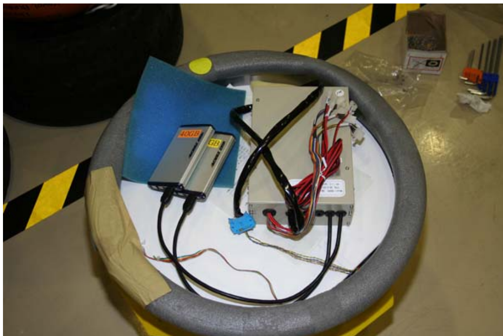
写真4 長期観測型海底地震計。中蓋の上にデータレコーダ、ハードディスクを設置した状態。
