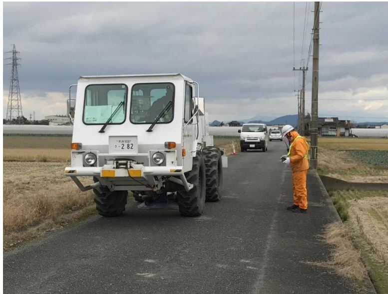
写真1 現地観測風景（中型バイブレータ）
