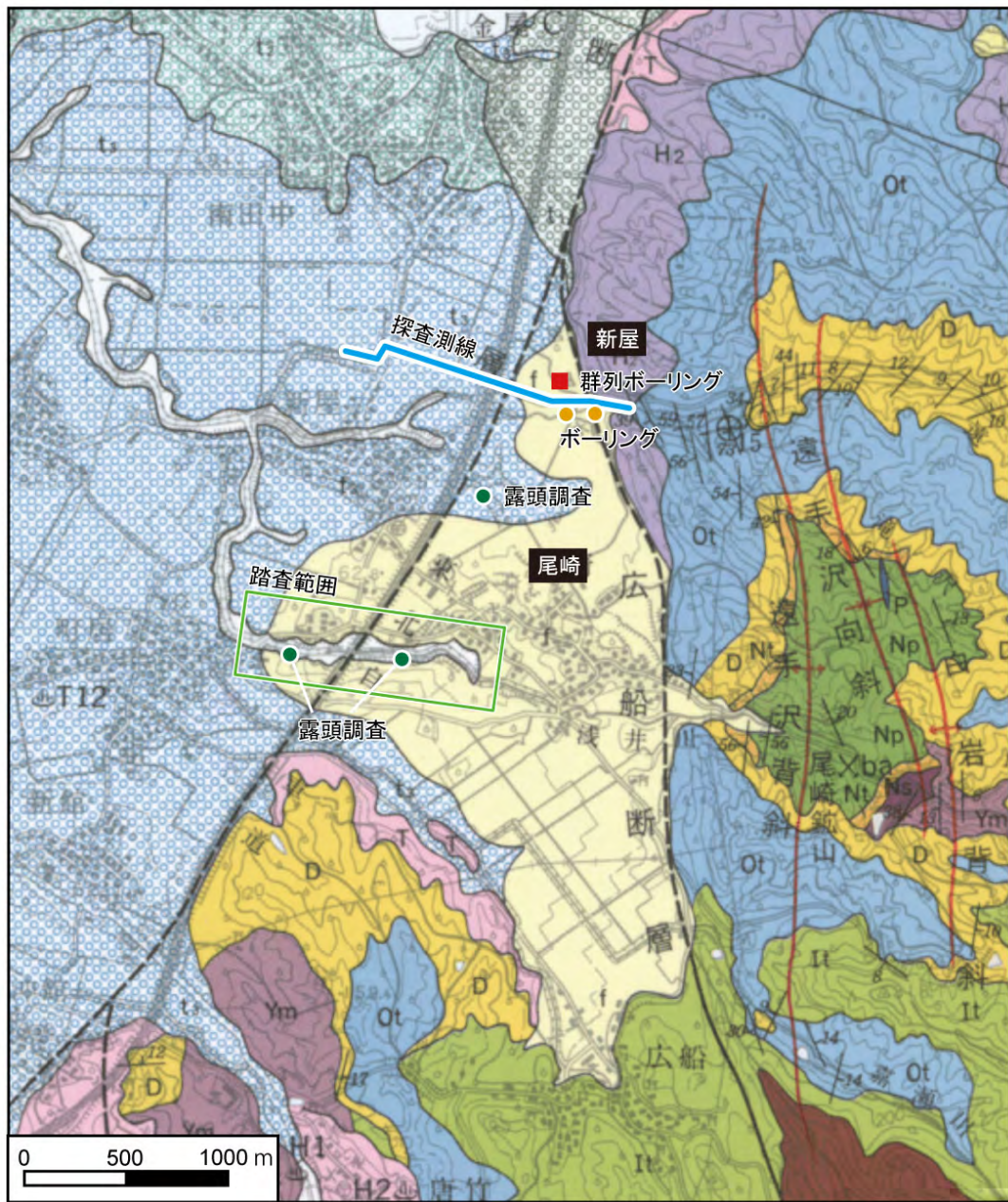
図 17 ボーリング調査及び地質踏査を実施した平川市新屋地区及び尾崎地区周辺の地質図 5 万分の 1 地質図「黒石」（村岡・長谷，1990）の該当部を抜粋し、加筆した。凡例は図 2 を参 照。
