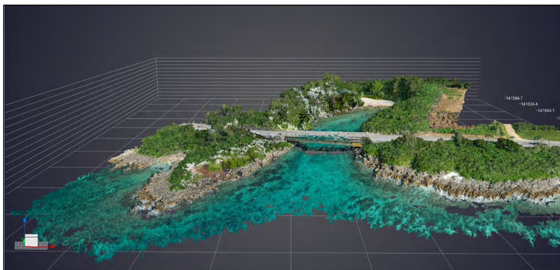
図 56 宮国地区深江橋周辺の 3D レーザースキャナー測量結果（鳥瞰）
