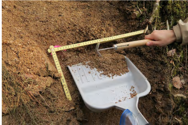
図 10 露頭からの試料採取状況
