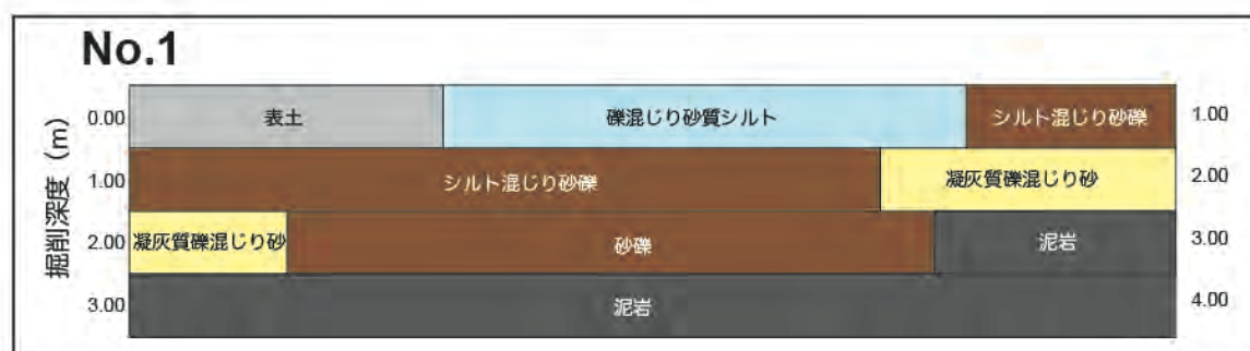
図 8 下井堀地区で掘削したボーリングコア（R4-No. 1）の層相区分図
