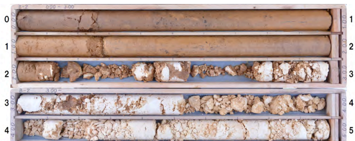
図 36 B-2 孔コア写真 数字は深度 (m)
