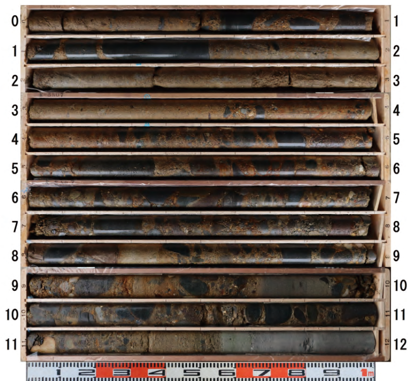
図 27 下井堀地区で掘削したボーリング (R5-No. 7) のコア写真
