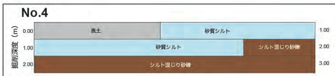
図 14 下井堀地区で掘削したボーリングコア（R4-No. 4）の層相区分図
