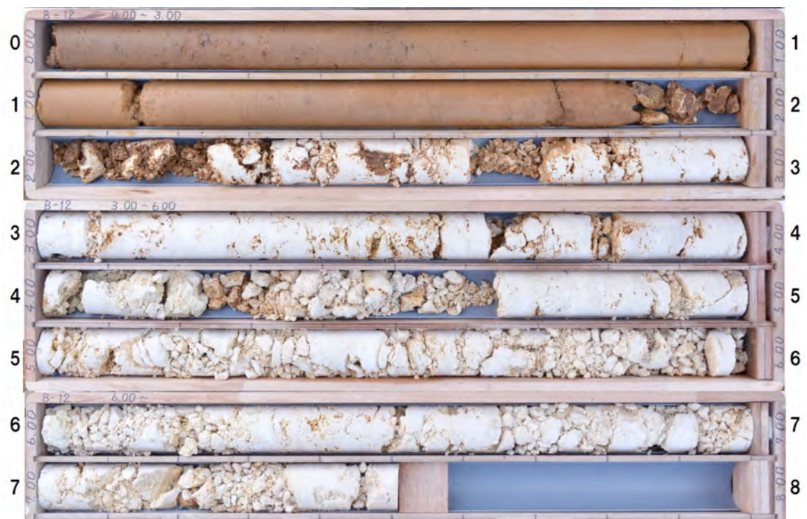
図 40 B-12 孔コア写真 数字は深度 (m)
