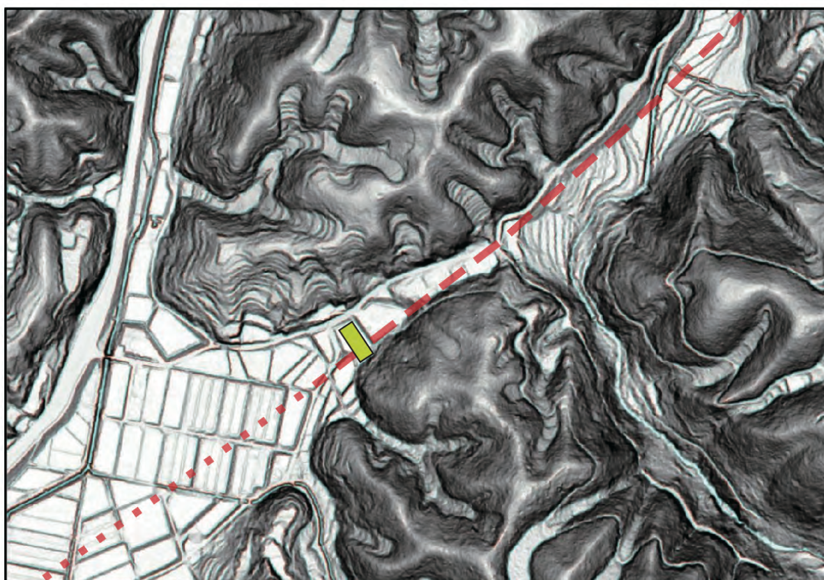
図 10 弥栄断層丸茂地区付近の地形陰影図と調査候補地 5 の位置 地形陰影図は、今回実施した航空レーザー測量による計測データを用いて作成した。赤破線は、活断層が通過すると想定される位置を示す。黄緑色の四角は、この地区でトレンチ調査を実施する候補地点を示す。
