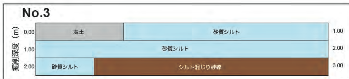
図 12 下井堀地区で掘削したボーリングコア (R4-No. 3) の層相区分図
