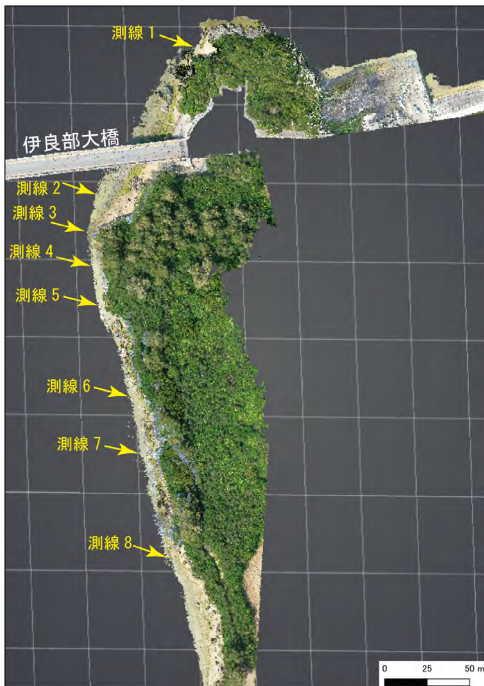
図 22 久貝地区伊良部大橋周辺の 3D レーザースキャナー測量結果 (平面)
