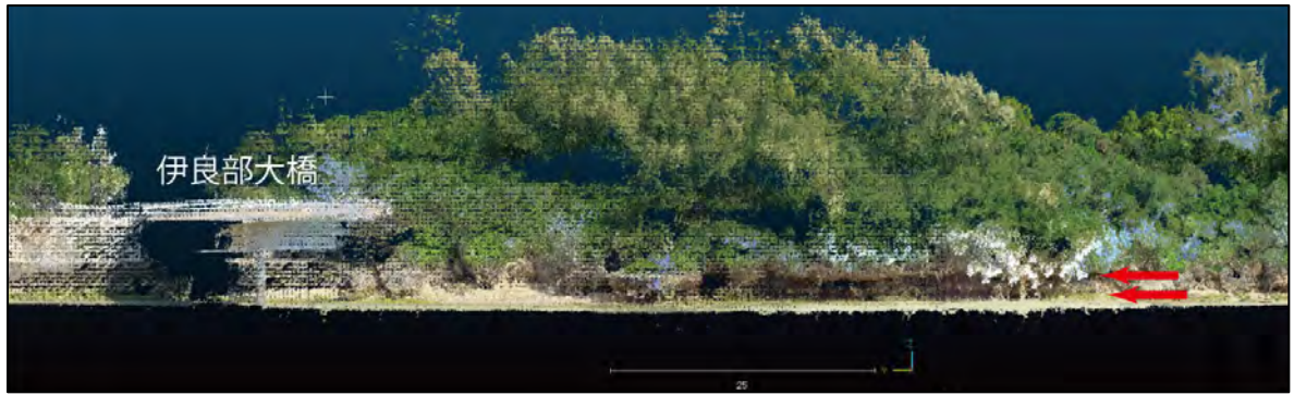
図 23 久貝地区伊良部大橋周辺の 3D レーザースキャナー測量結果（海岸から） 赤矢印はノッチの位置を示す。
