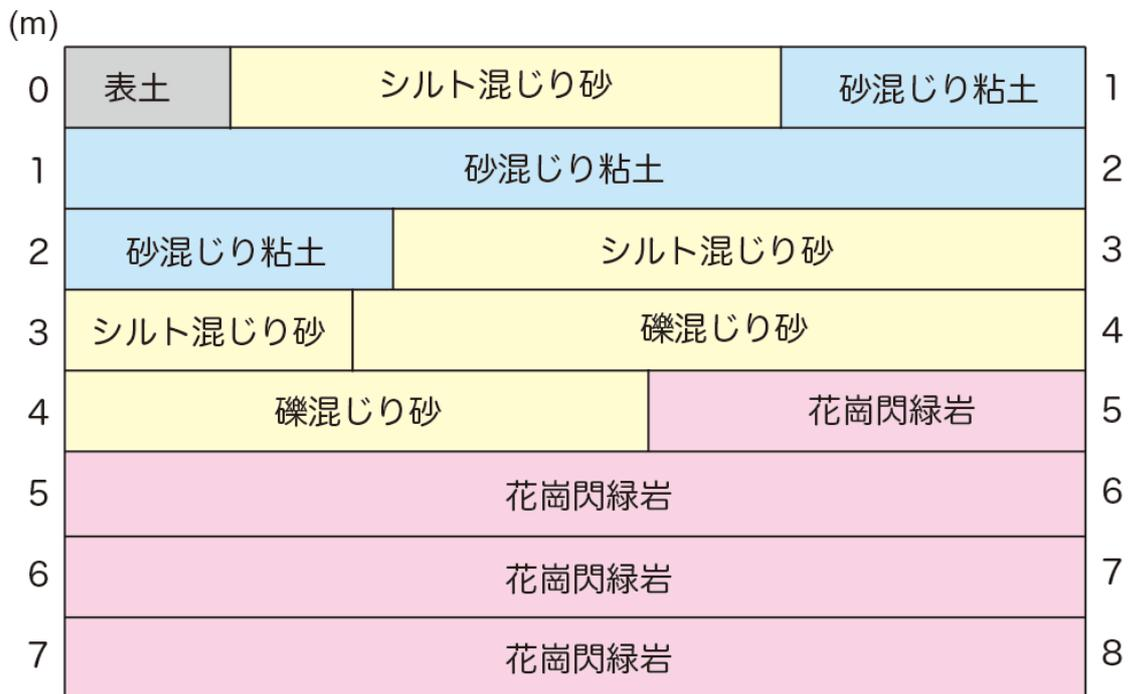
図8 赤河断層帯南東部（恵那市長島町久須見）井洞地区で掘削した IBR-1 のボーリングコア写真（上）と層相区分図（下）
