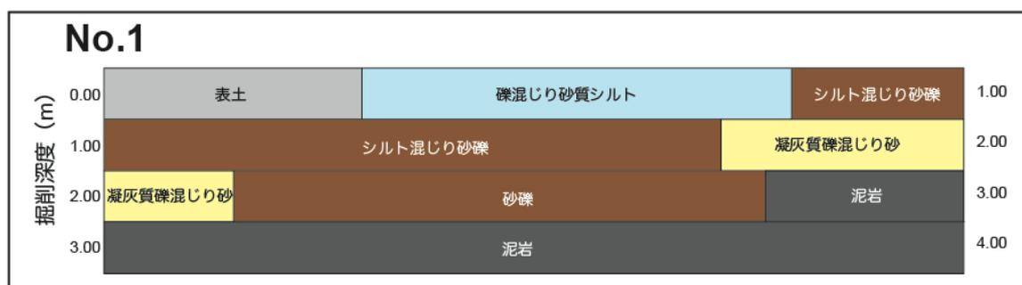
図 8 下井堀地区で掘削したボーリングコア (R4-No. 1) の層相区分図
