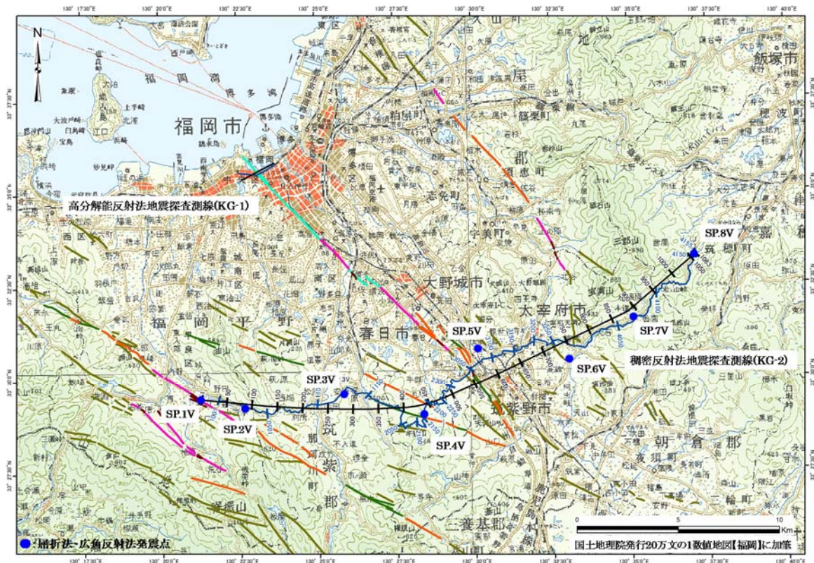
図 2-1-1 調査測線図。図中の黒実線が解析を行った CMP 重合測線、青実線が探査測線を示す。北側が高分解能反射法測線、南側が稠密反射法測線、青丸は屈折法・高角反射法の発振点を示す。カラーの太実線は活断層およびリニアメントを示す（サブテマ 1-1 による）。国土地理院発行 20 万分の 1 数値地図【福岡】に加筆。
