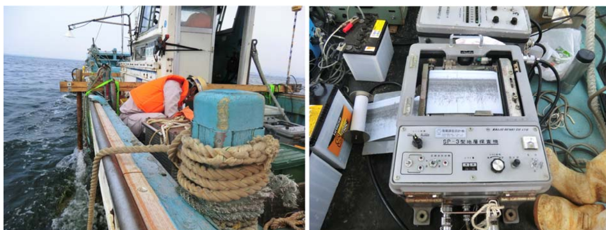
図 1 漁船を用いた海上音波探査の実施状況（左）と音響記録機器（右）
