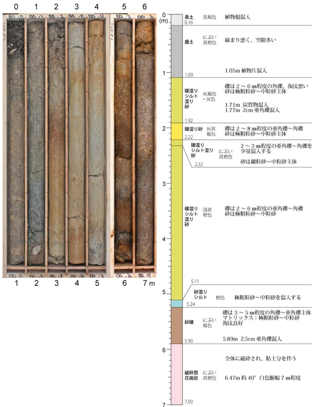
図4 上大利No. 3孔のコア写真と地質記載
