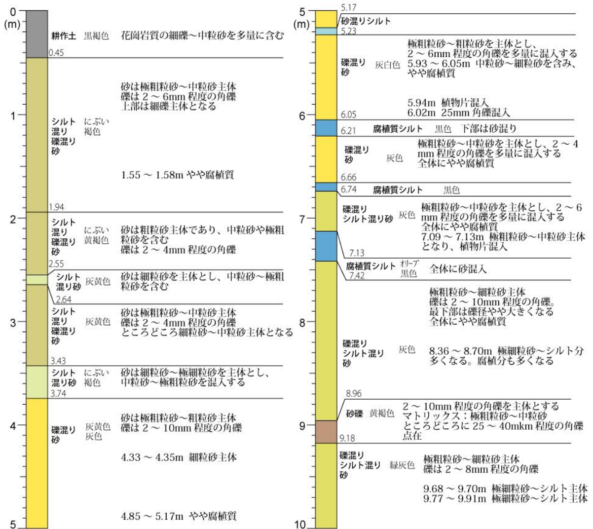
図 8 武蔵S9孔のコア写真と地質記載
