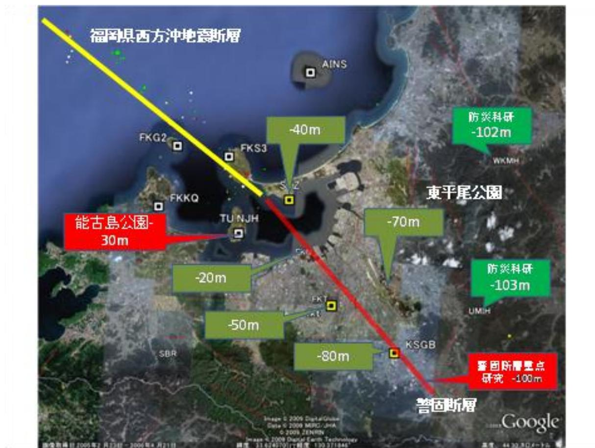
図3 警固断層周辺の地震観測点分布。吹き出し中の数字はボーリング孔深度。
