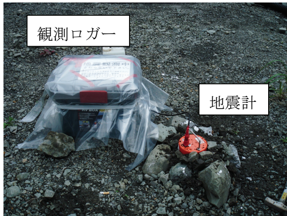
写真 1 神縄・国府津－松田断層帯北縁部周辺に設置された機動的地震観測点。
