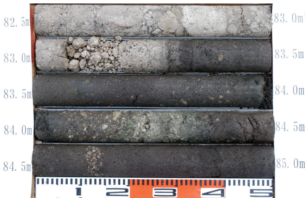
写真 2 南足柄市壺下地区における活断層調査ボーリングの深度 83.3m（海拔約・40m）に見られる箱根小原台軽石（Hk-OP）。足柄平野が沈降したことを示唆する。
