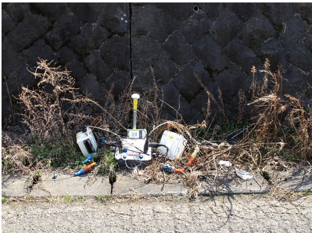
図 11 独立型収録装置 MS2000 の設置。
