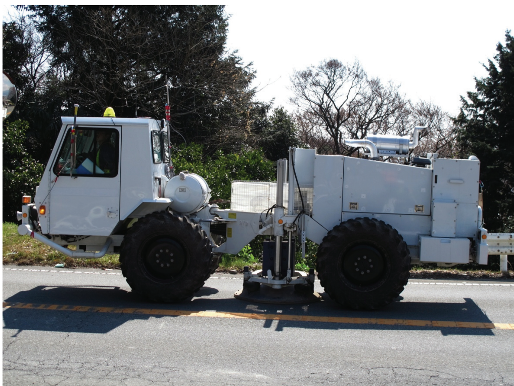
図 12 中型バイブレーターの発振作業。
