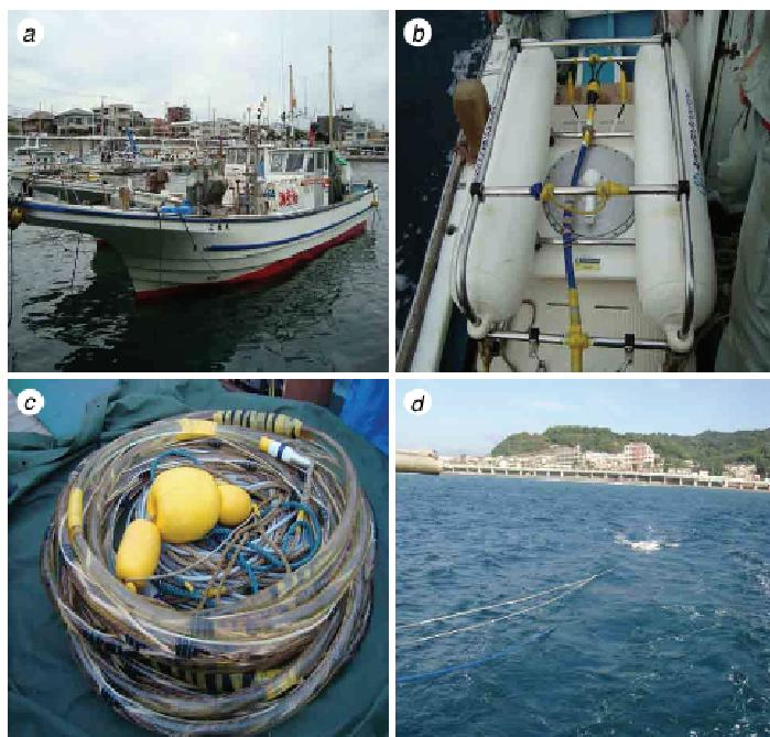
図3 探査装置。(a) 探査船(小田原市漁協所属正春丸, 4.8トン), (b) 発振装置(英国 Applied Acoustic 社製ブーマーシステム)、(c) 受信装置(12チャンネルストリーマーケーブル), (d) 発振装置曳航風景(背後は大磯丘陵)。
