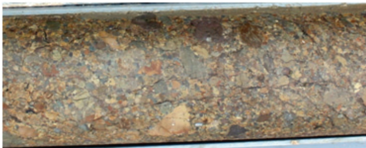
図5 本調査のコア試料（36.70～36.90m）で見られるデイサイト質凝灰岩。
