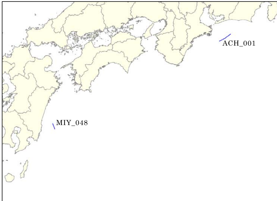
図 55 横ずれ断層のすべり方向の感度解析に使用した断層モデル
