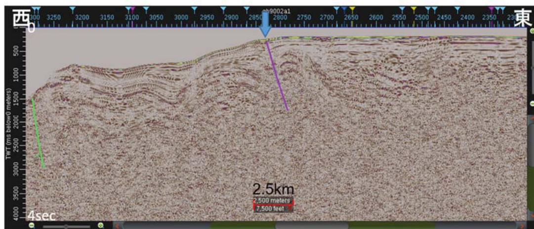
図 87 新規断層 NTG-38 のエリア A の反射記録断面図（時間断面）
