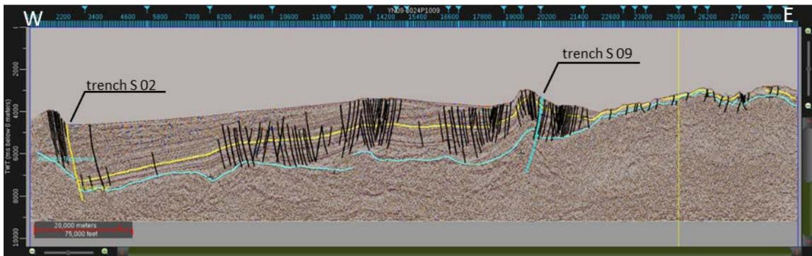
前弧海盆を東西に横切る反射法地震探査断面図（石垣島沖）
