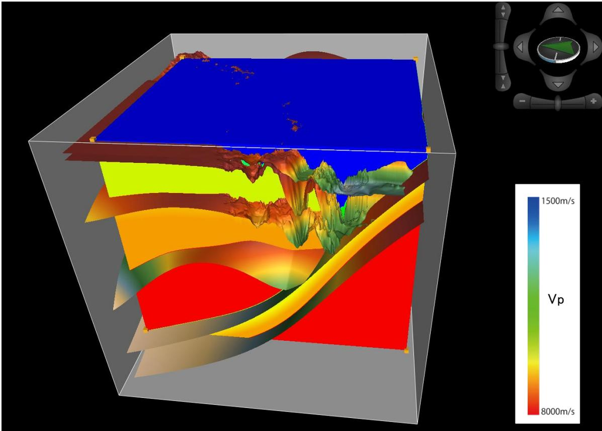
三次元地震波（P波）速度構造モデル概観（南西諸島海域南部）
