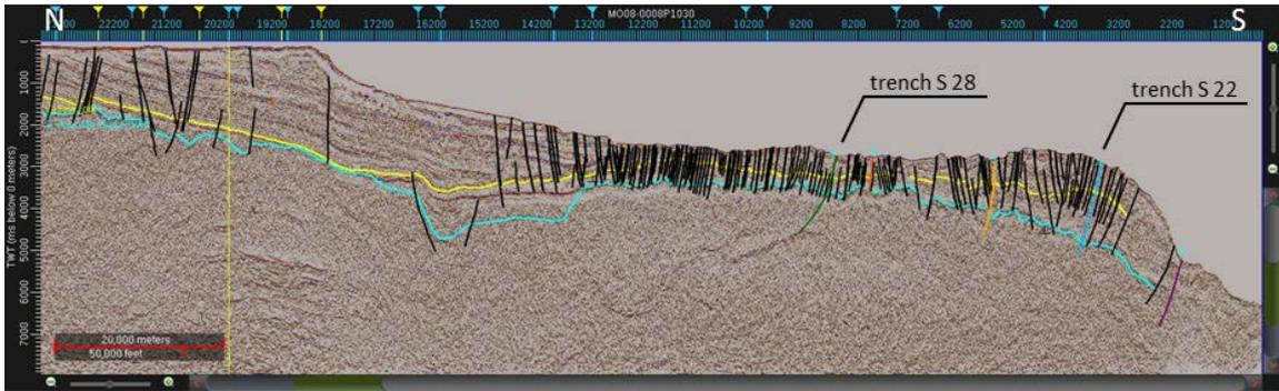
前弧海盆を横切る反射法地震探査断面図（慶良間ギャップ）
