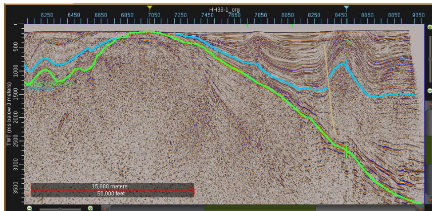
図 96 稚内沖の東西方向の時間断面図。明瞭な背斜構造と堆積層内に発達する褶曲構造が確認できる。
