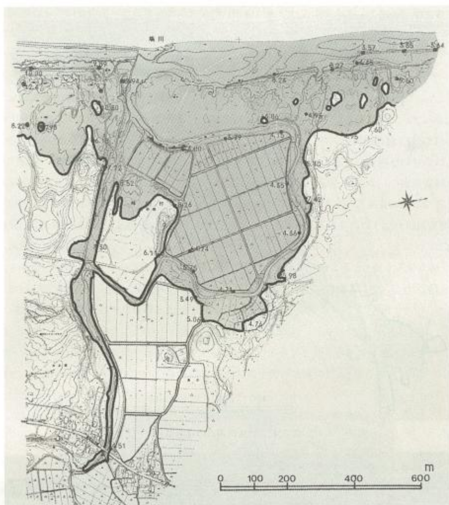
図 3.4-2 堀川河口の浸水域。[1983 年日本海中部地震震害調査報告書]。
