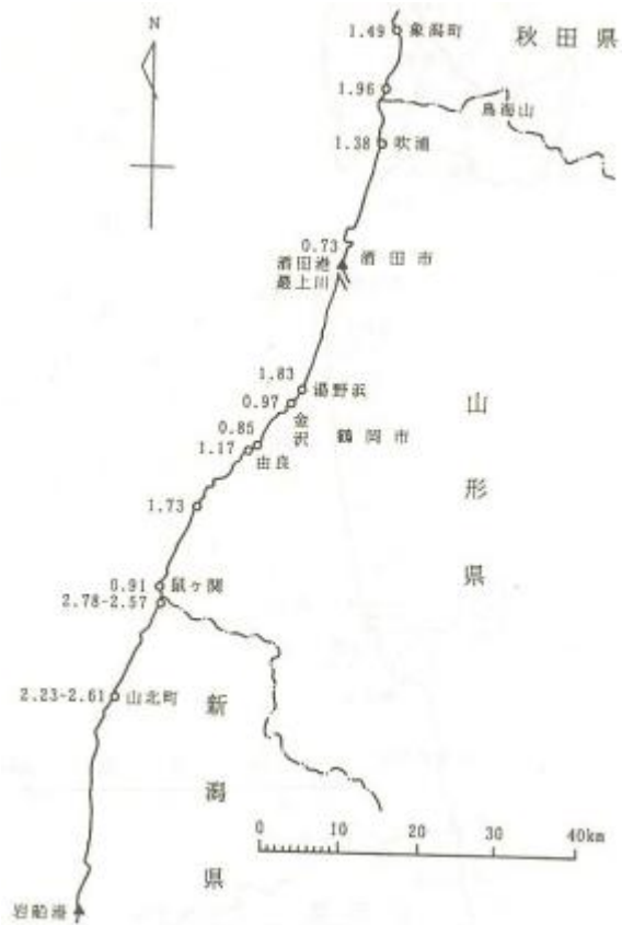
図 2.2-8 山形県沿岸での津波打ち上げ高 [1993 年北海道南西沖地震震害調査報告：震害調査シリーズ 3]。
