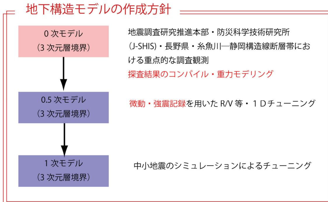
図 1 深部地下構造モデル化の流れ図
