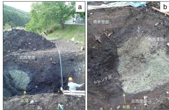
図 4 金沢下地区トレンチ壁面写真。(a) 北西壁面 A とバルジ西縁。(b) トレンチ底と南東壁面。断層の連続が 3 次元的に把握できる。断層の走向は 36° W。
